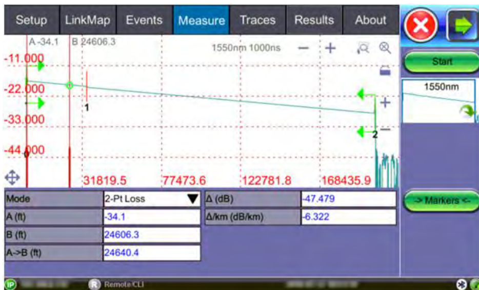
Vista bidirezionale: prima traccia caricata (prima di selezionare la traccia di direzione inversa)
