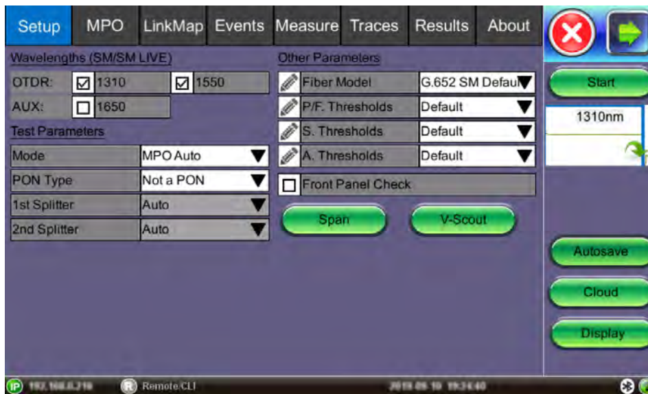
Schermata OTDR (con switch MPO collegato)
